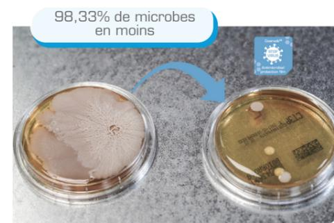
Les résultats démontrent une **réduction effective et majeure** du nombre de **micro-organismes** sur des surfaces équipées du dispositif Coversafe™.
